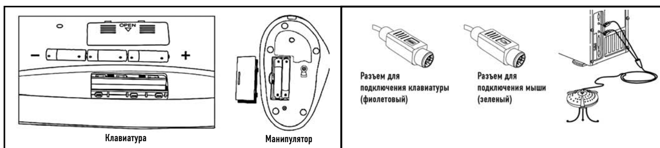
Рис. 1. Установка элементов питания.
