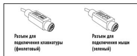
Рис. 3. Типы разъемов кабеля для подключения устройств.
