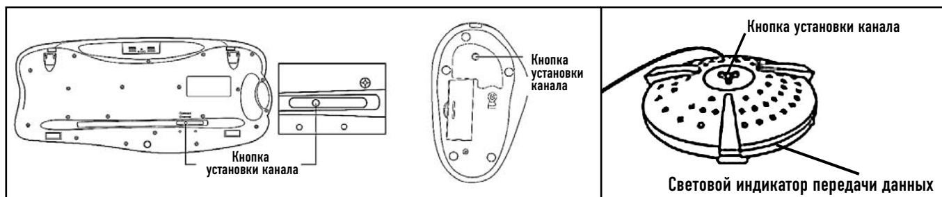
Рис. 4. Настройка радиоканала на устройствах.
